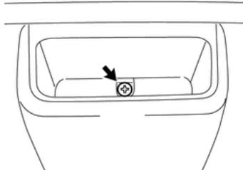
6. ОТВЕРНИТЕ БОЛТ И СНИМИТЕ ПАНЕЛЬ ОБЛИ-
