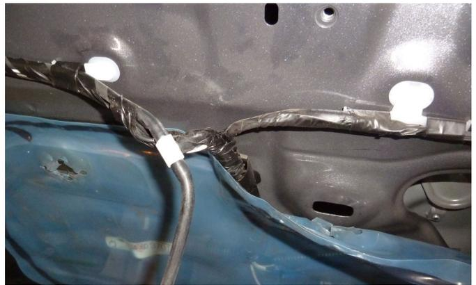
12. СОЕДИНИТЕ ТРОЙНИК С КЛАПАНОМ ШЛАНГОМ, ЗАКРЕПИТЕ ЕГО СТЯЖКАМИ НА ШТАТНОЙ ПРОВОДКЕ.
