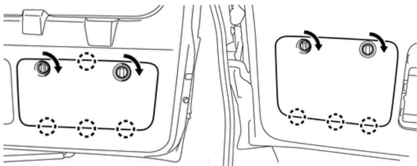
4. СНИМИТЕ КРЫШКУ ЗАМКА ДВЕРИ БАГАЖНОГО
